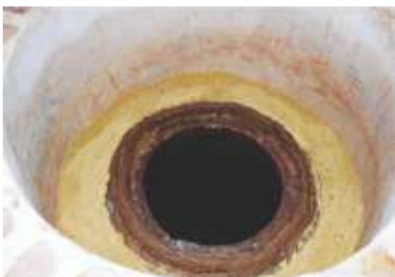
Applicazione dell'argilla sul collo del Qvevri.
