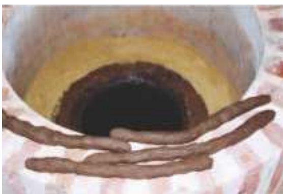
Applicazione dell'argilla sul collo del Qvevri
