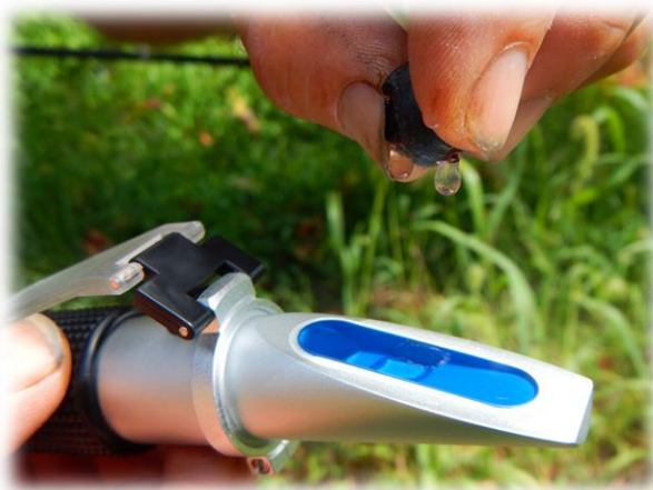
სურათი 12, შაქრის შემცველობის გასაზომად რეფრაქტომეტრის გამოყენებით
